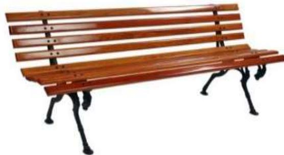
Os bancos serão instalados nos locais indicados nas plantas de mobiliário urbano. Terão estrutura de ferro com assento e encosto de madeira de lei, com espessura mínima de 3cm e 10 peças com 1,50m de comprimento. Serão fixados no solo através chumbamento com uma camada fina de concreto com traço 1:3:5 (cimento/areia/brita).
