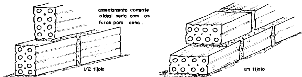
Figura 1 - Execução de alvenaria utilizando tijolos furados.
