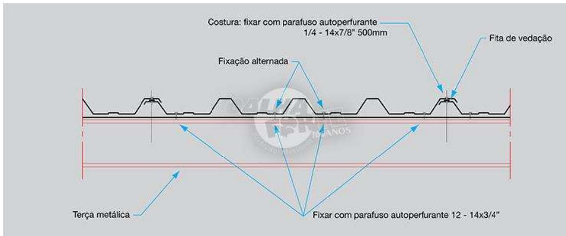
Na hora da montagem, observe a direção do vento. Monte as telhas em sentido contrário ao do vento; a montagem deve ser iniciada do beiral da cumeeira. Se a obra tiver duas águas opostas, a cobertura deverá ser feita, simultaneamente, em ambos os lados. Assim haverá coincidência das ondulações na cumeeira.
